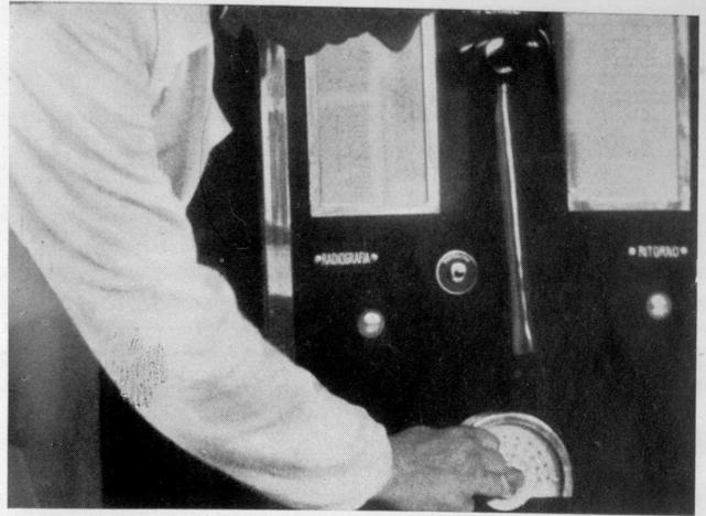
Fig. 35 - La cassetta radiografica viene sistemata nel portacassetta
