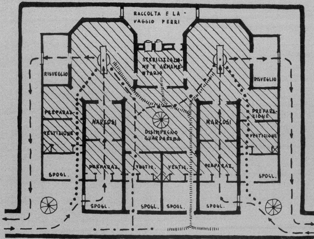
Schema di gruppo operativo. La parte tratteggiata indica i locali che si trovano a pressione d'aria superiore alla pressione atmosferica. - Schema dei percorsi: punteggiati = chirurgo; tratteggiati con frecce = malato; punti e linee = assistenti; a piccole linee normali al percorso = infermieri.
