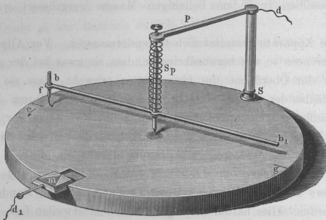
der Breite des Plättchens, über welches das Federchen hinstreift. Um das Federchen mit verschiedenen Geschwindigkeiten bewegen zu können, ist es befestigt am Ende eines etwa 30 Centimeter langen Metallbälkchens. Dies ist in seiner Mitte mit einer zu ihm senkrechten in Spitzen laufenden Axe fest verbunden. Um die Axe win-
