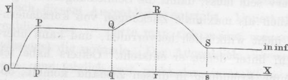
den zweiten ansteigenden Bogen. Die Ordinate erreicht darin für einen endlichen Abscissenwerth  $Or$  ein Maximum  $rR$ , nimmt dann aber wieder ab bis zu einem Werthe, der unter der ersten Stufe liegt und den sie in infinitum beibehält (Fig. 16). Wenn schon die in Fig. 11 dargestellte Versuchsreihe einen Wink zu Gunsten der zweiten Annahme giebt, so kann zwischen beiden Möglichkeiten doch nur der ganz directe Versuch entscheiden.
